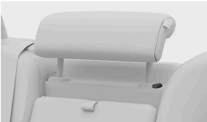
Verriegelungstaste an der Kopfstütze
