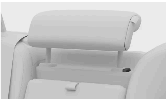
Verriegelungstaste an der Kopfstütze
