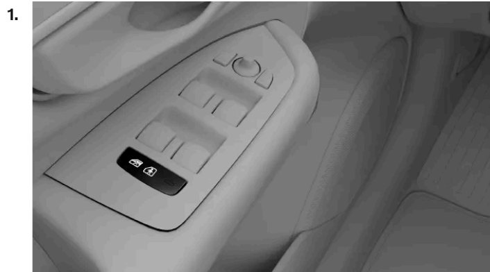
Position der Kindersicherungstaste in der Türverkleidung
