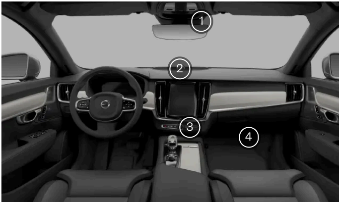
Klimasensoren im Innenraum
