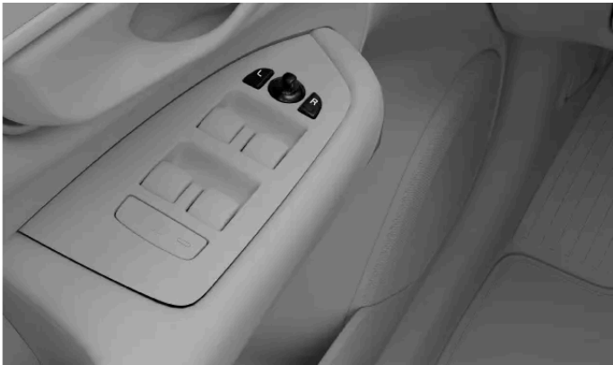
Bedienelemente zum Einstellen der Außenspiegel
