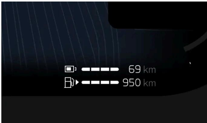
Ihre Reichweite hängt in erster Linie von der Batterieladung Ihres Fahrzeugs, dem verbleibenden Kraftstoff in Ihrem Fahrzeugtank und Ihrer Fahrweise ab, kann aber auch durch externe Bedingungen beeinflusst werden. Der Ladezustand der Batterie und die voraussichtliche Reichweite werden auf dem Fahrerdisplay angezeigt. Zur Berechnung der voraussichtlichen Reichweite werden das aktuelle und frühere Fahrprofile herangezogen.
