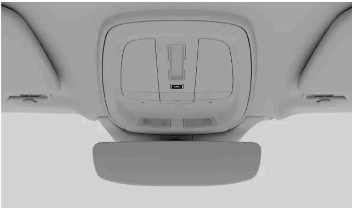
Taste für die volle Innenbeleuchtung an der Deckenkonsole
