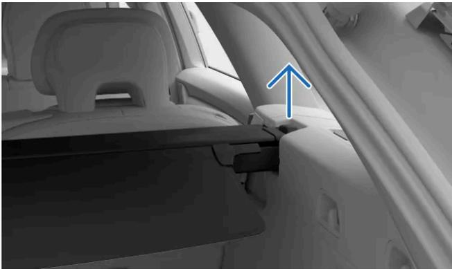
Heben Sie die Laderaumabdeckung zum Entfernen vollständig aus den Vertiefungen an der Rückseite des Kofferraums.
