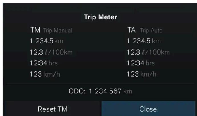
Ihr Fahrzeug verfügt über einen Tageskilometerzähler und einen Kilometerzähler. Der Tageskilometerzähler kann Informationen über die Fahrstrecke und die Fahrzeit sowie über den durchschnittlichen Kraftstoffverbrauch und die Fahrgeschwindigkeit anzeigen.
