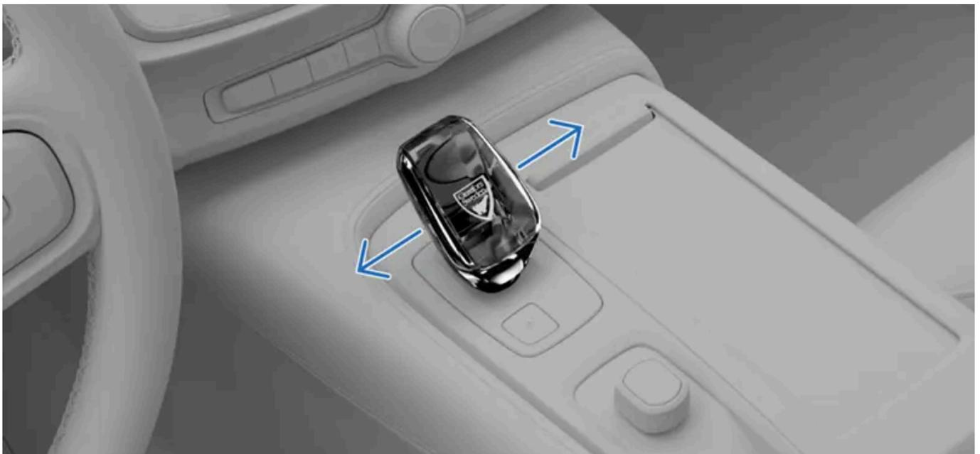
Nachdem Sie die Getriebestellung B ausgewählt haben, können Sie die Gänge manuell schalten, indem Sie den Wählhebel nach links oder rechts bewegen.
