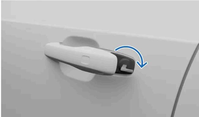
5 Drehen Sie den Schlüssel um 45 Grad gegen den Uhrzeigersinn wieder zurück in seine Ausgangsposition und ziehen Sie ihn ab.
