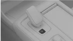
Wenn P ausgewählt ist, wird das Getriebe mechanisch blockiert, um versehentliches Schalten zu vermeiden.
