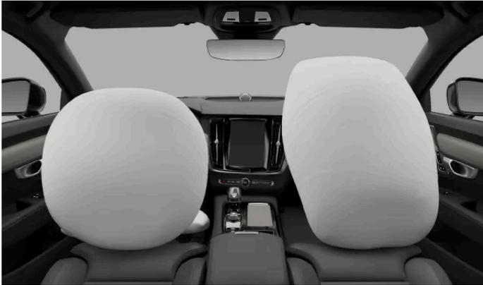
Auf Fahrer- und Beifahrerseite befindet sich jeweils ein Frontairbag. Der Airbag auf der Fahrerseite ist im Lenkrad, der Airbag auf der Beifahrerseite hinter der Verkleidung oberhalb des Handschuhfachs untergebracht.
