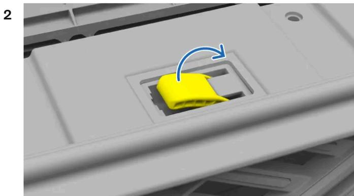
Suchen Sie den zweiten Hebel unter der Vorderkante der Frontklappe und ziehen Sie ihn nach rechts.
