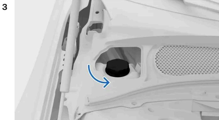
Schrauben Sie den Deckel des Kühlmittelbehälters ab.
