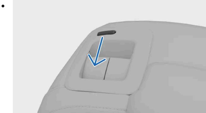
Ziehen Sie am Griff der Rückenlehne. Eine rote Anzeige an der Lehnenverriegelung bedeutet, dass die Rückenlehne nicht mehr verriegelt ist.
