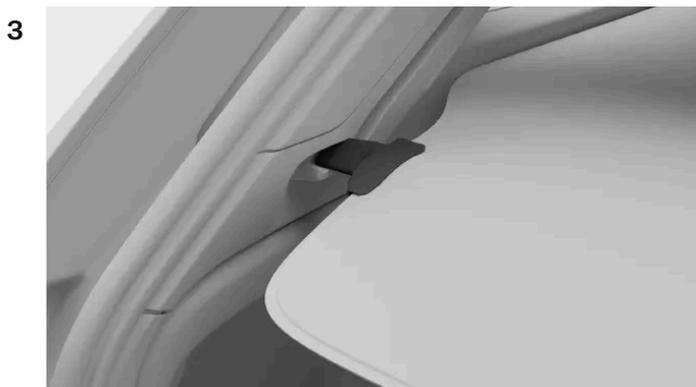
Führen Sie die Enden der Laderaumabdeckung in die Rillen in die eingerastete Position.
