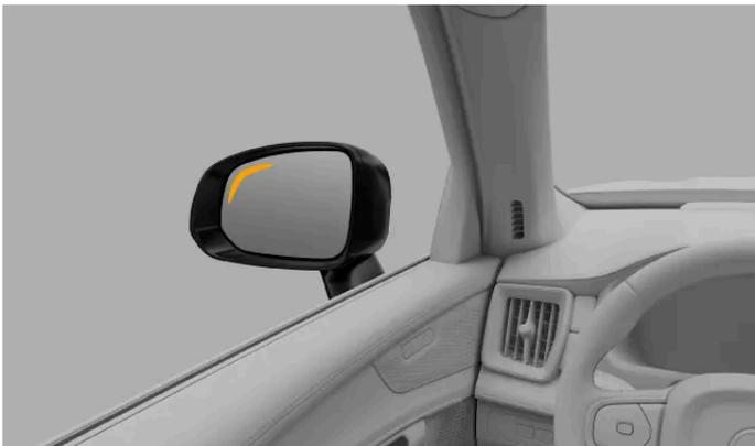
Wenn erkannt wird, dass sich ein Fahrzeug in Ihrem toten Winkel befindet oder sich diesem nähert, schaltet sich ein Licht am Außenspiegel ein.
