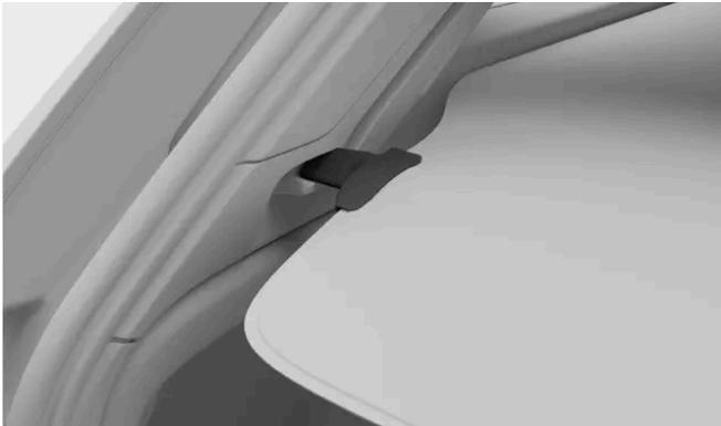
Heben Sie das Ende der Laderaumabdeckung an und ziehen Sie am Griff, um die Abdeckung freizugeben. Jetzt kann die Laderaumabdeckung eingezogen werden.
