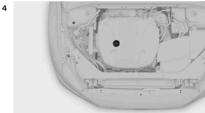
Schrauben Sie den Deckel langsam ab, um den Druck abzulassen.
