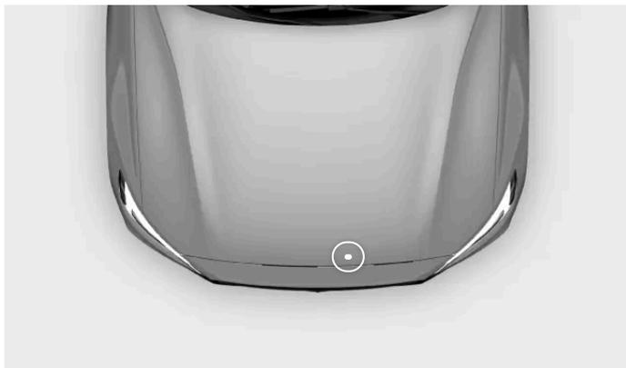
Der zweite Hebel befindet sich auf Fahrerseite unter der Vorderkante der Frontklappe.
