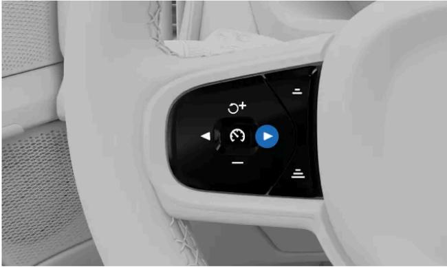
Drücken Sie die Umschalttaste ► am Lenkrad.
