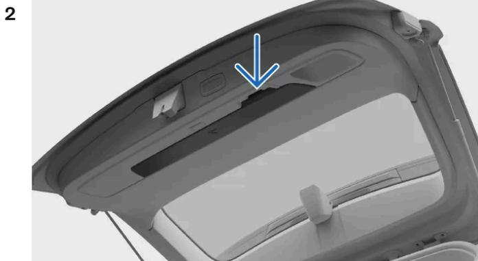
Das Warndreieck befindet sich in einem Fach innen am Kofferraumdeckel. Ziehen Sie zum Öffnen am Griff.
