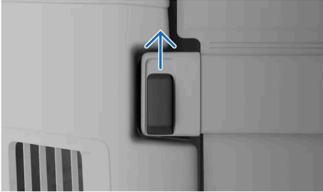
An den Enden der Laderaumabdeckung befinden sich Entriegelungsknöpfe. Drücken Sie den Entriegelungsknopf auf einer Seite der Abdeckung nach vorn und halten Sie ihn in dieser Position, während die das Ende der Abdeckung anheben. Wiederholen Sie diesen Schritt auf der anderen Seite.
