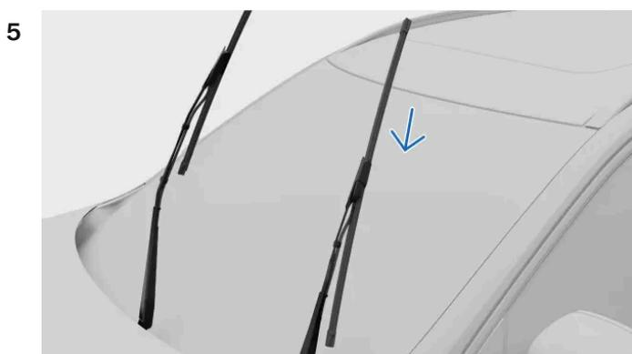
Beachten Sie, dass das Wischerblatt für die Fahrerseite länger ist als das für die Beifahrerseite. Schieben Sie das Wischerblatt auf den Wischerarm. Achten Sie darauf, dass der Stift am Wischerarm in die Öffnung am Wischerblatt greift. Drücken Sie das Wischerblatt in den Wischerarm, bis Sie ein Klicken hören.
