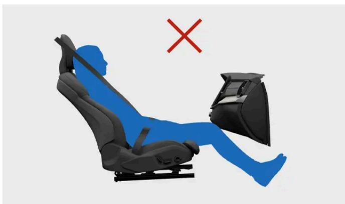
Neigen Sie die Rückenlehne nicht in eine liegende Position. Der Sicherheitsgurt muss gespannt über der Schulter liegen.
