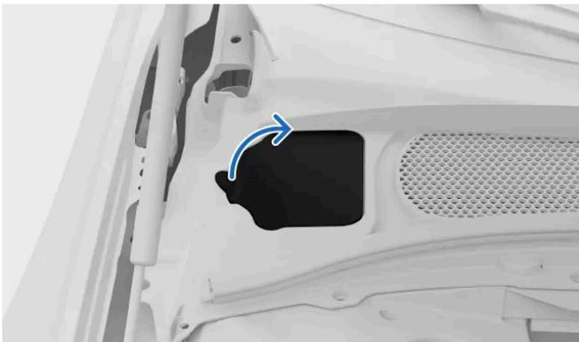
Öffnen Sie die Klappe in der linken oberen Ecke des Motorraums, um an den Kühlmittelbehälter zu gelangen.
