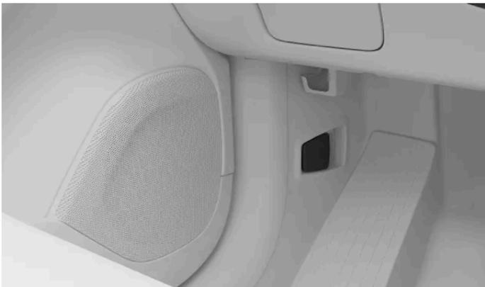
Der erste Hebel befindet sich auf Fahrerseite direkt neben dem Türscharnier unter dem Armaturenbrett.
