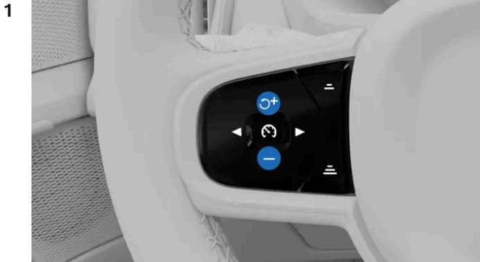
Stellen Sie die Sollgeschwindigkeit mit den Lenkradtasten ein.
