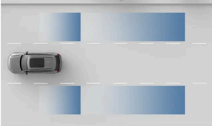
Bereiche der Radarerkennung.
