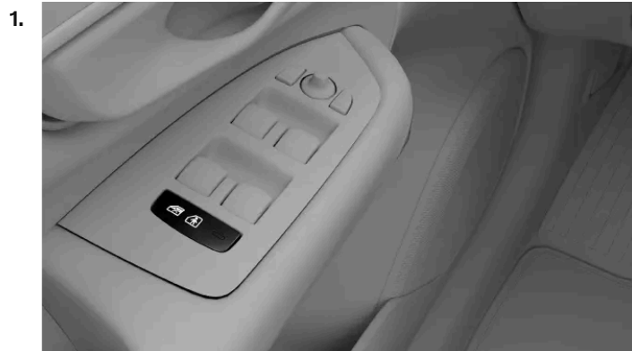
Position der Kindersicherungstaste in der Türverkleidung
