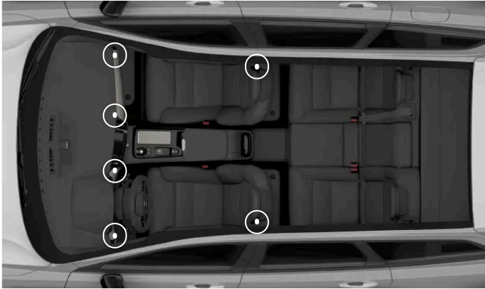
Lage der verstellbaren Lüftungsdüsen
