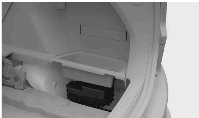
Lage des Sicherungskastens
