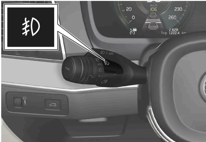
Taste für Nebelscheinwerfer.
