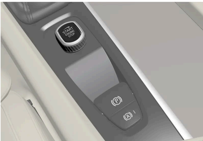
Startschalter auf der Tunnelkonsole.
