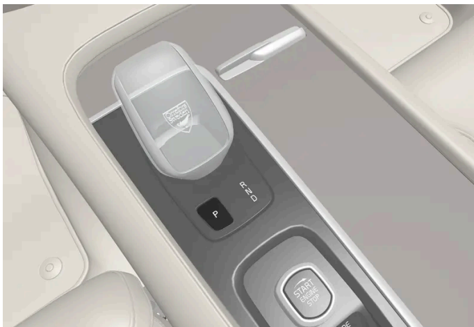
Übersicht über Wählhebel und Stellung P.
