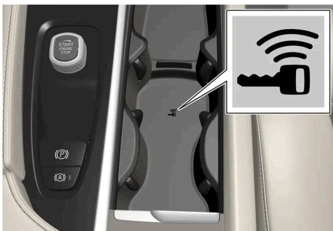
Lage des Schlüssellesegeräts an der Tunnelkonsole.
