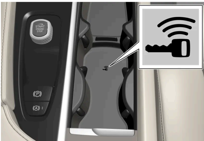
Lage des Schlüssellesegeräts an der Tunnelkonsole.
