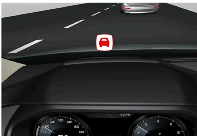
Symbol der Aufprallwarnung auf der Windschutzscheibe
