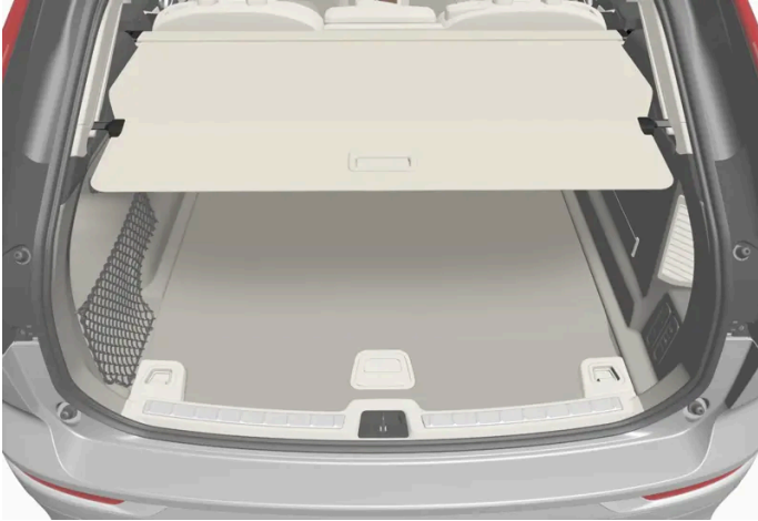
Die Abdeckung in der vollständig ausgezogenen Stellung.
