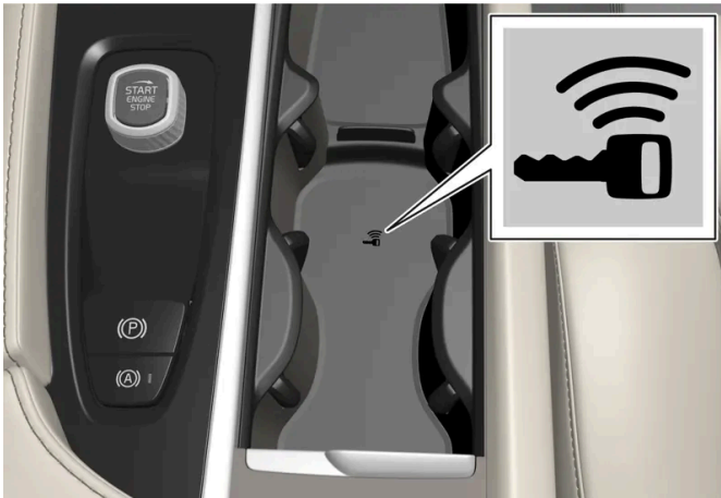
Lage des Schlüssellesegeräts an der Tunnelkonsole.
