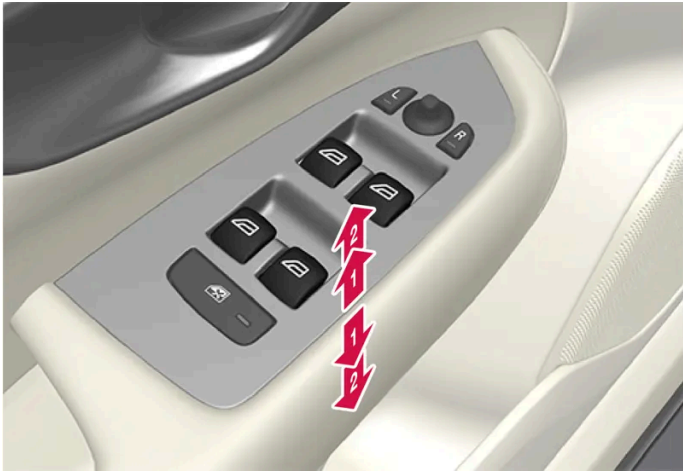
Betätigung der Fensterheber.
