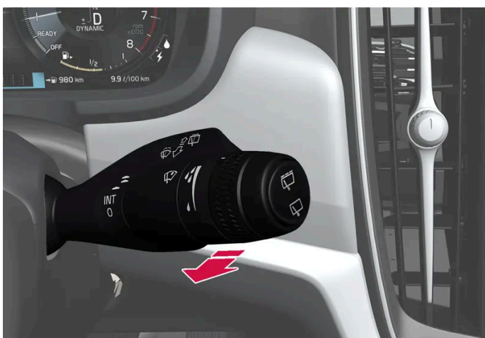
Waschfunktion, rechter Lenkradhebel.
