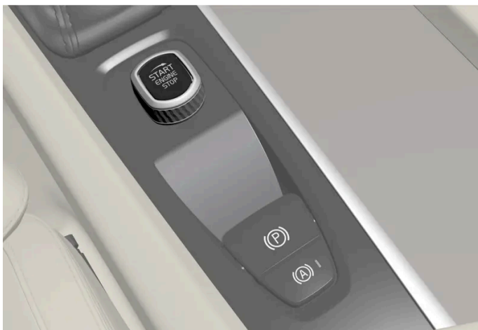
Startschalter auf der Tunnelkonsole.
