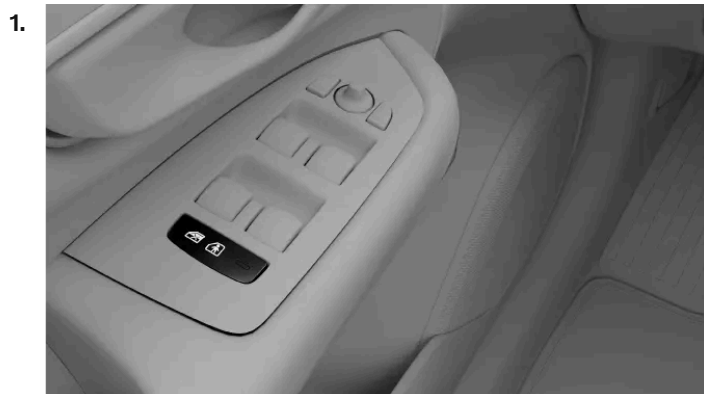
Position der Kindersicherungstaste in der Türverkleidung
