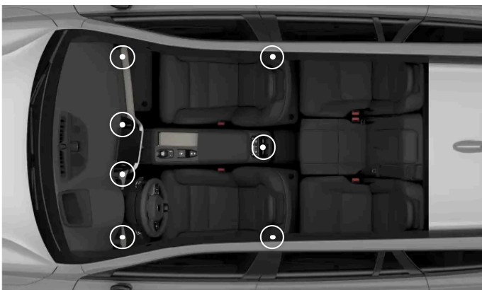
Lage der verstellbaren Lüftungsdüsen
