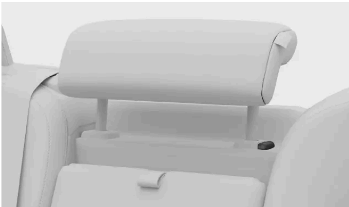
Verriegelungstaste an der Kopfstütze
