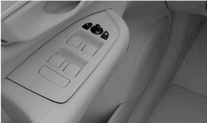
Bedienelemente zum Einstellen der Außenspiegel
