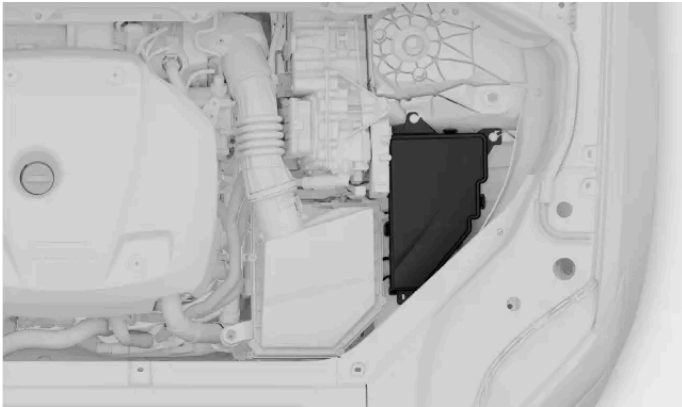
Lage des Sicherungskastens
