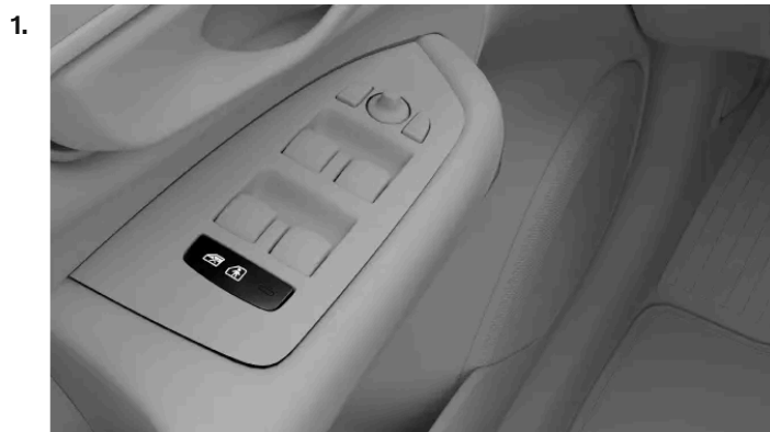
Position der Kindersicherungstaste in der Türverkleidung
