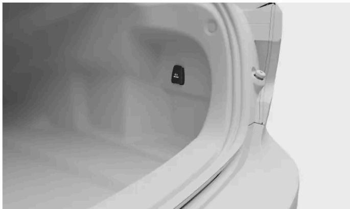
Die 12-V-Steckdose an der rechten Kofferraumwand
