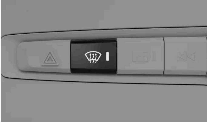
Enteisungstaste im Tastenfeld unter dem Center Display
