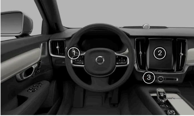
Lage der Bedienelemente für die Außenbeleuchtung
