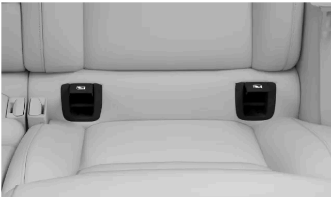
Lage der ISOFIX-Verankerungspunkte an den äußeren Rücksitzen
