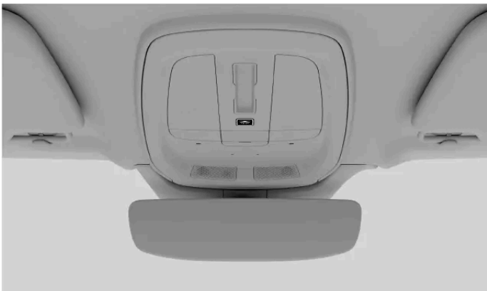
Die Taste zum Deaktivieren der automatischen Beleuchtung an der Deckenkonsole
