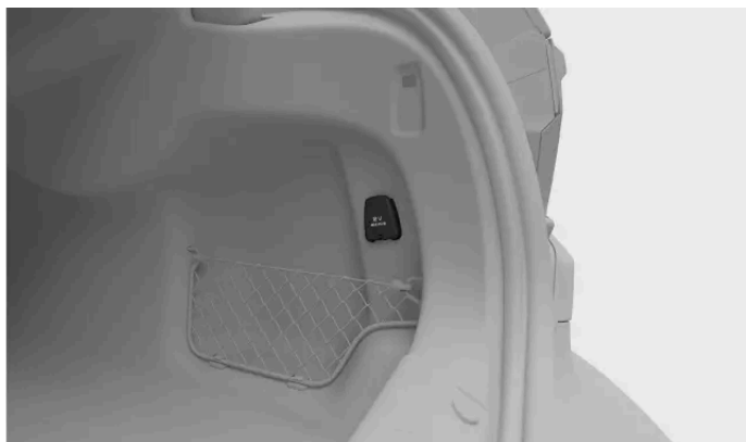
Die 12-V-Steckdose an der rechten Kofferraumwand
