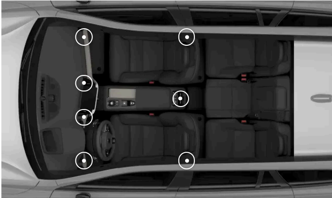
Lage der verstellbaren Lüftungsdüsen
