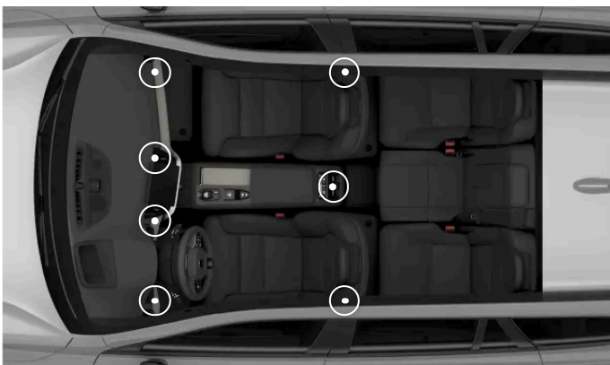
Lage der verstellbaren Lüftungsdüsen
