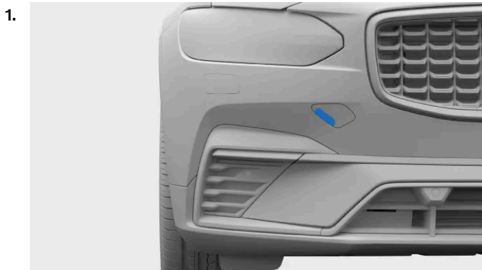
Vordere Abdeckung zur Befestigung der Abschleppöse
