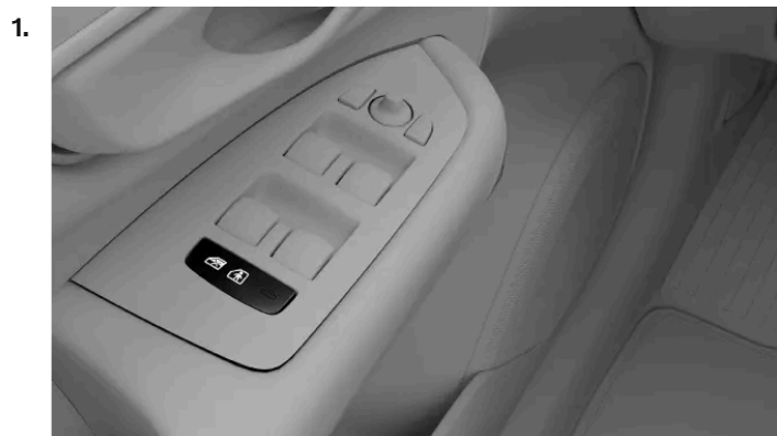
Position der Kindersicherungstaste in der Türverkleidung
