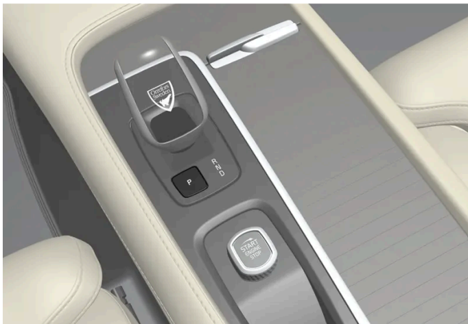
Übersicht über Wählhebel und Stellung P.
