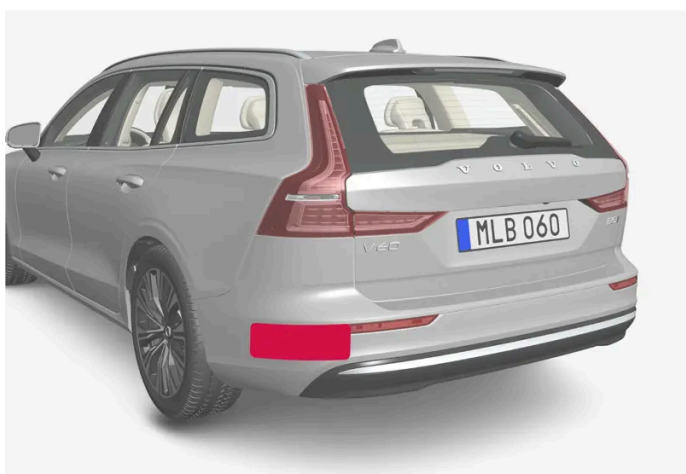
Lage der hinteren Radarmodule
