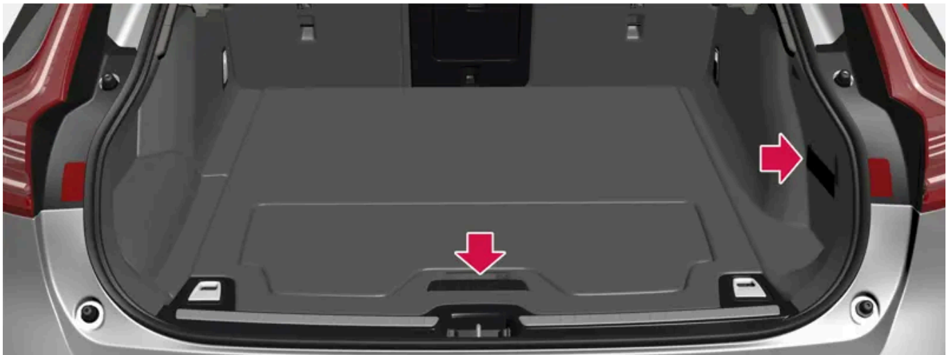
Gepäckraum mit elastischem Band sowie Ablagefach unter dem Gepäckraumboden.
