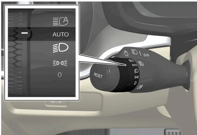
Drehring am Lenkradhebel in Stellung AUTO .
