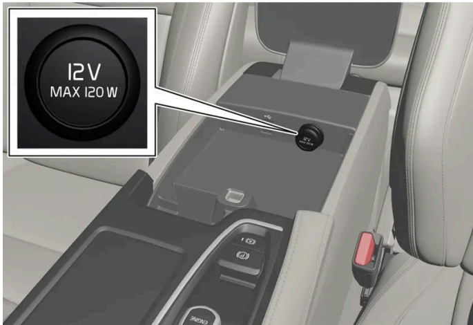
12-V-Steckdose in der Tunnelkonsole, vorn.
