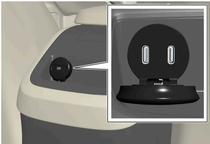
USB-Anschlüsse (Typ C) in der Tunnelkonsole, Fond.
