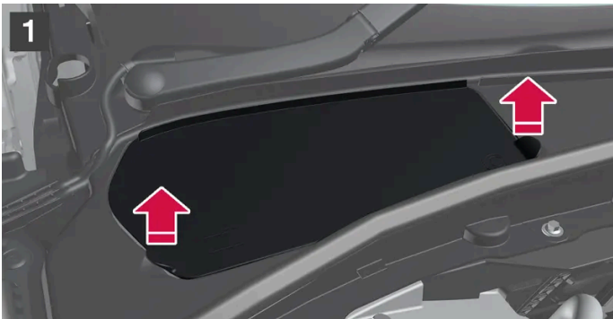
Ausgleichsbehälter der Kühlanlage, Rechtslenker.
