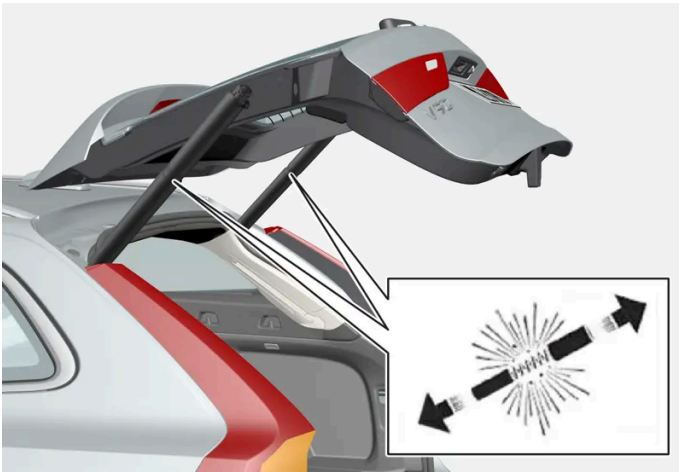
Vorgespannte Federn der elektrisch betätigten Heckklappe.
