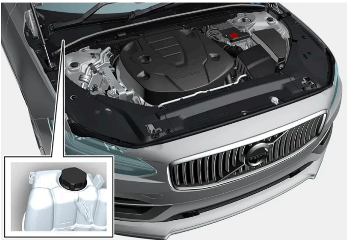
Ausgleichsbehälter der Kühlanlage, Rechtslenker.
