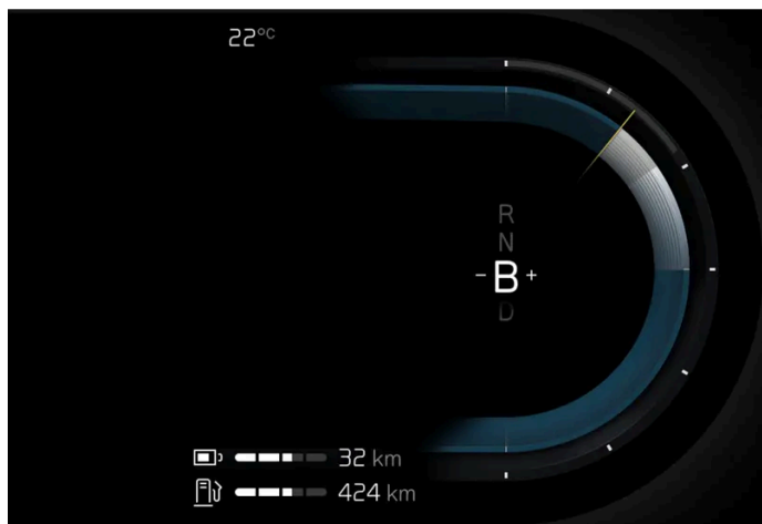
Übersicht über Bremsstellung auf dem Fahrerdisplay.
