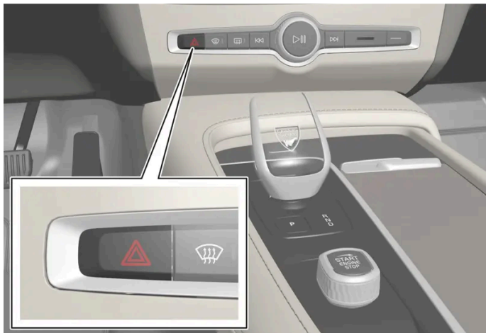
Taste für Warnblinkanlage.
