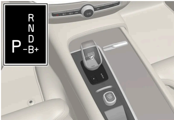
Wählhebel und Schaltmuster auf dem Fahrerdisplay.
