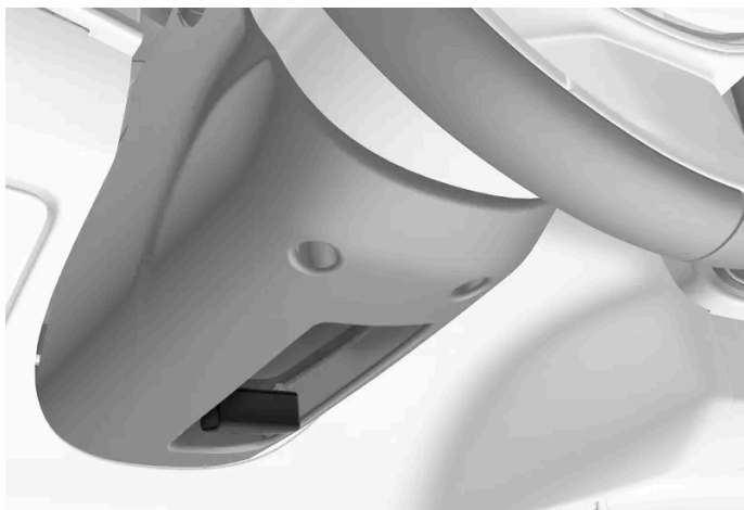
Hebel für die Lenkradverstellung.
