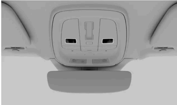
Die vorderen Leseleuchten an der Deckenkonsole
