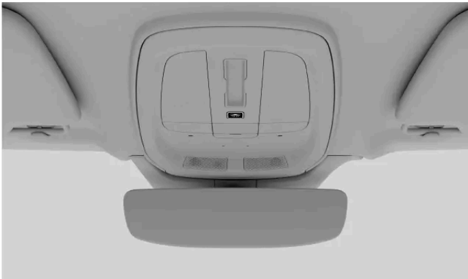
Die Taste zum Deaktivieren der automatischen Beleuchtung an der Deckenkonsolle
