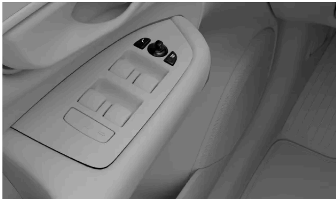
Bedienelemente zum Einstellen der Außenspiegel
