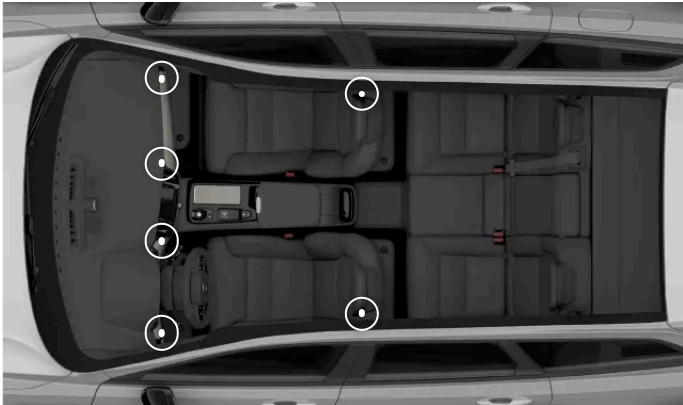
Lage der verstellbaren Lüftungsdüsen
