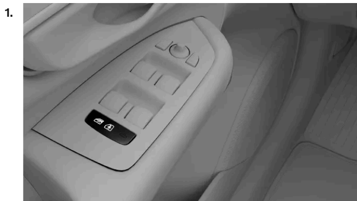
Position der Kindersicherungstaste in der Türverkleidung
