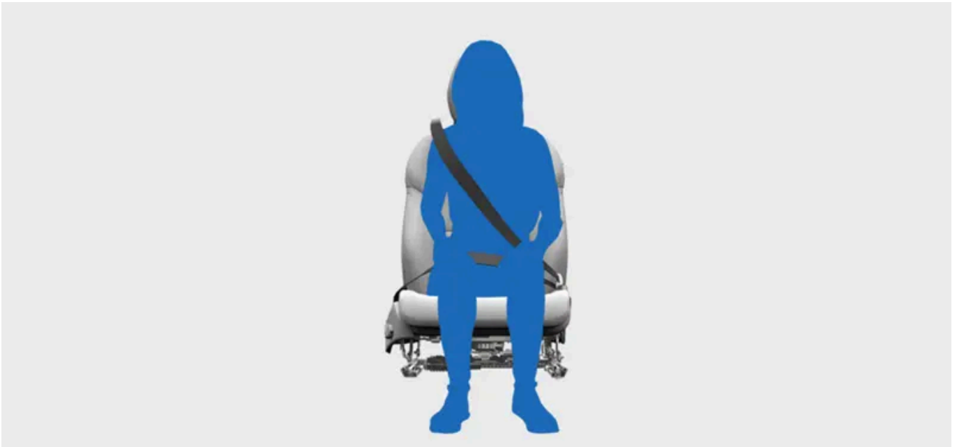
Richtig angelegter und eingestellter Sicherheitsgurt.
