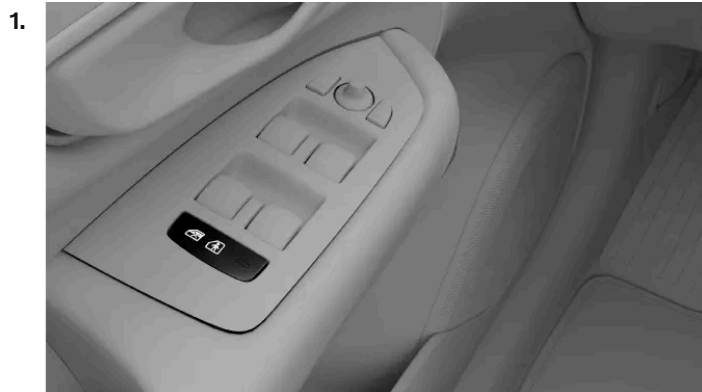
Position der Kindersicherungstaste in der Türverkleidung
