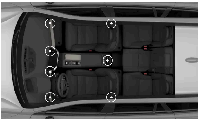
Lage der verstellbaren Lüftungsdüsen
