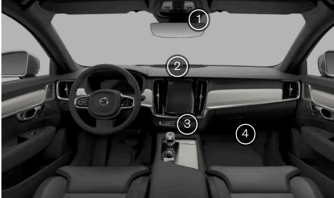
Klimasensoren im Innenraum
