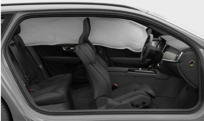
Auf einer Seite des Fahrzeugs ausgelöster Kopf-/Schulterairbag.
