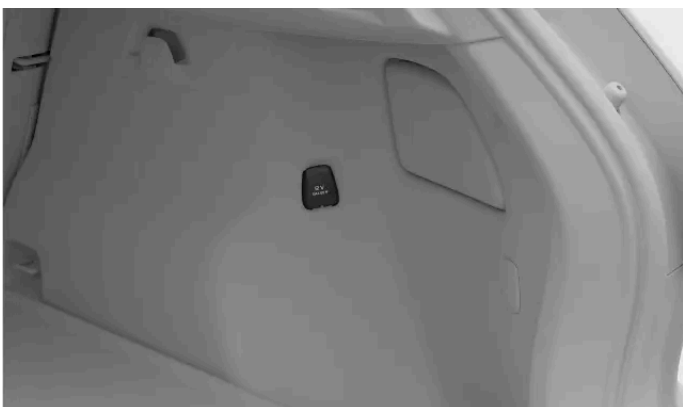
Die 12-V-Steckdose an der rechten Kofferraumwand
