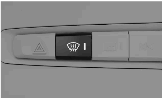
Enteisungstaste im Tastenfeld unter dem Center Display
