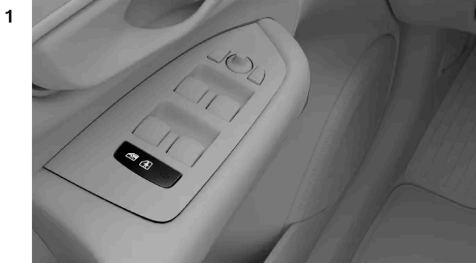
Position der Kindersicherungstaste in der Türverkleidung
