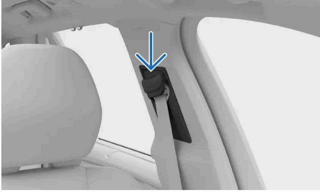
Oberer Verankerungspunkt des Sicherheitsgurts.
