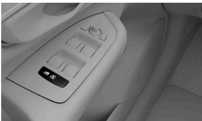
Position der Kindersicherungstaste in der Türverkleidung
