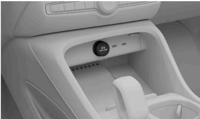
Die 12-V-Steckdose in der Tunnelkonsole
