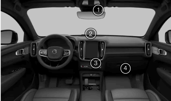
Klimasensoren im Innenraum
