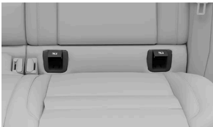
Lage der ISOFIX-Verankerungspunkte an den äußeren Rücksitzen
