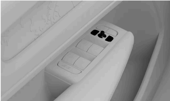
Bedienelemente zum Einstellen der Außenspiegel
