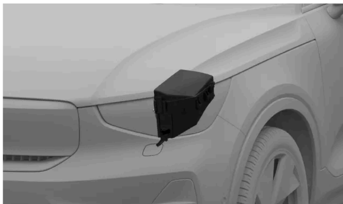
Lage des Sicherungskastens
