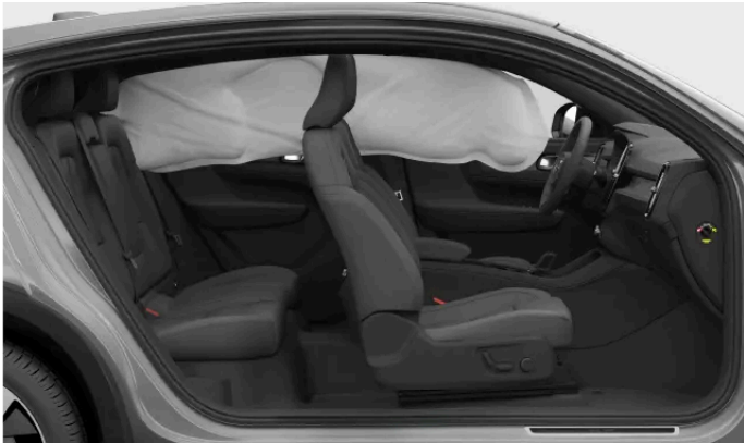
Auf einer Seite des Fahrzeugs ausgelöster Kopf-/Schulterairbag.
