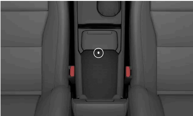
Position des Backup-Lesegeräts im Ablagefach der Tunnelkonsole
