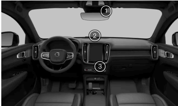
Klimasensoren im Innenraum
