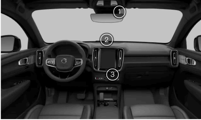
Klimasensoren im Innenraum
