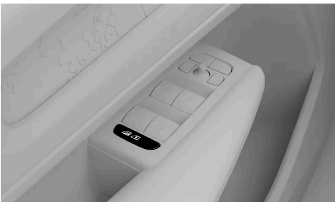
Position der Kindersicherungstaste in der Türverkleidung
