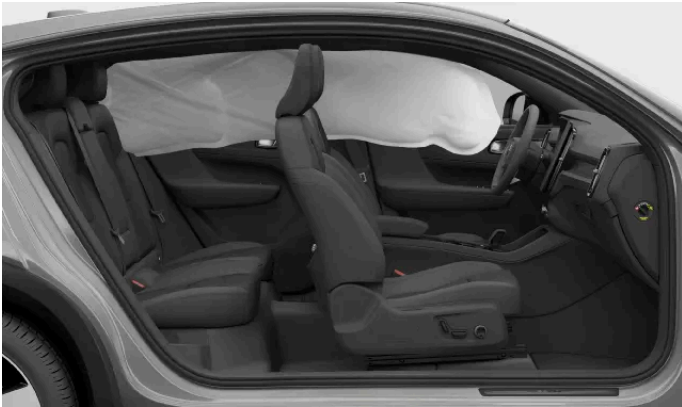
Auf einer Seite des Fahrzeugs ausgelöster Kopf-/Schulterairbag.
