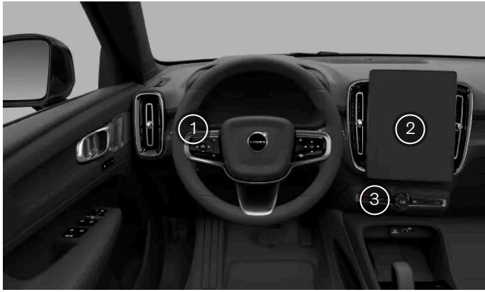
Lage der Bedienelemente für die Außenbeleuchtung
