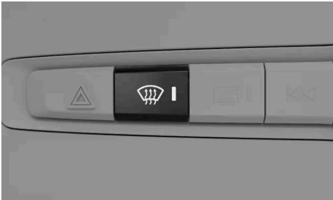
Enteisungstaste im Tastenfeld unter dem Center Display
