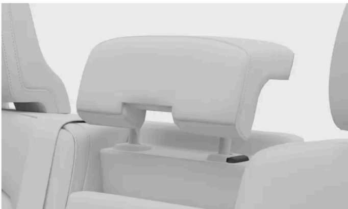
Verriegelungstaste an der Kopfstütze
