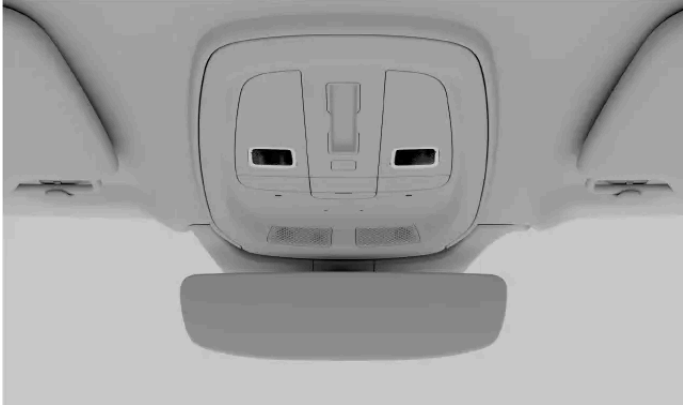
Die vorderen Leseleuchten an der Deckenkonsolle
