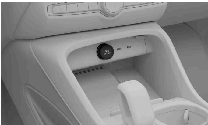
Die 12-V-Steckdose in der Tunnelkonsole
