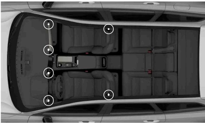
Lage der verstellbaren Lüftungsdüsen
