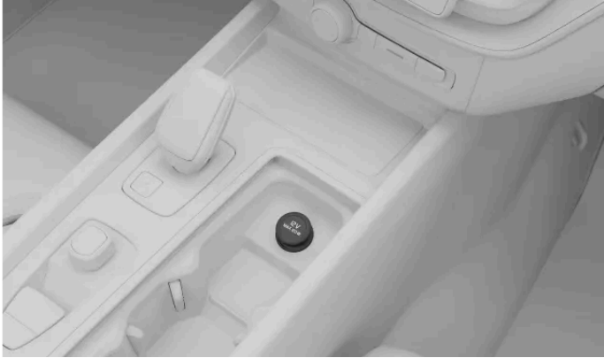
Die 12-V-Steckdose in der Tunnelkonsole
