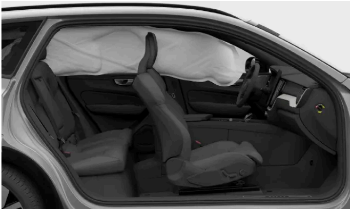
Auf einer Seite des Fahrzeugs ausgelöster Kopf-/Schulterairbag.
