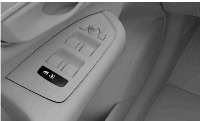
Position der Kindersicherungstaste in der Türverkleidung
