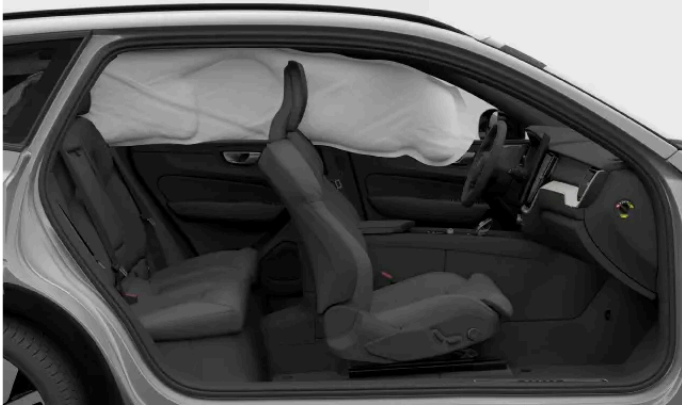
Auf einer Seite des Fahrzeugs ausgelöster Kopf-/Schulterairbag.
