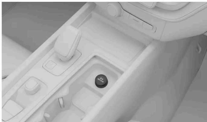
Die 12-V-Steckdose in der Tunnelkonsole
