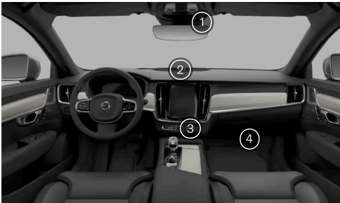
Klimasensoren im Innenraum
