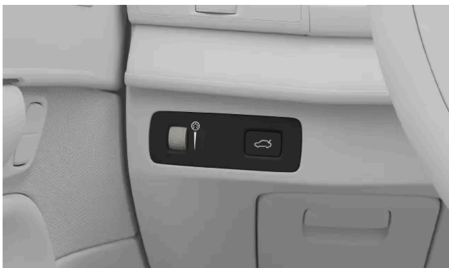
Daumenrad zur Einstellung der Innenbeleuchtung
