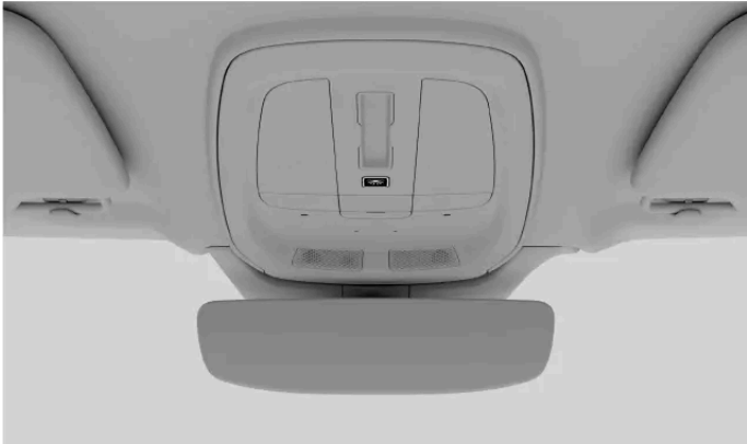
Taste für die volle Innenbeleuchtung an der Deckenkonsolle
