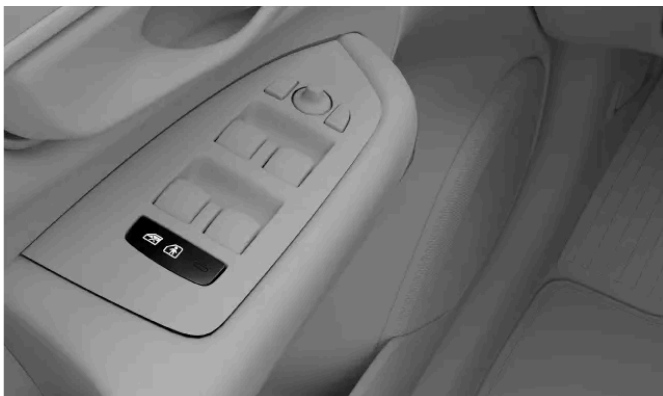
Position der Kindersicherungstaste in der Türverkleidung
