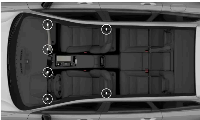
Lage der verstellbaren Lüftungsdüsen
